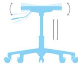
Mecanismo Balance360° / elevación gas
