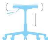
Mecanismo Balance360° / elevación gas
