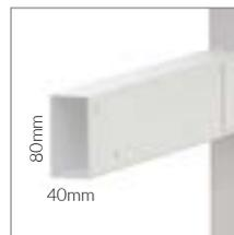
Travesaño de unión columnas elevables en tubo perfilado decapado, de sección 80x40mm y espesor 1,5mm. Unión a las columnas mediante tornillos de rosca métrica.
