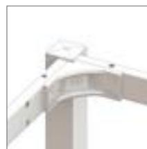
Travesaños y travesaños longitudinales de sección rectangular 50×20mm y de 1,5mm de espesor, unidos por escuadras angulares de aluminio moleado a presión, de 100×100xh 50mm
